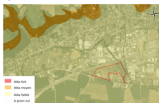
Figure 50 : Retrait-gonflement des argiles
