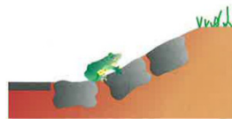
Figure 93 - Afin d'éviter ce problème, la pose de bordures inclinées (< 45 %) est à privilégier (plus facilement franchissables). Le marché offre aujourd'hui cette solution de remplacement aux bordures verticales. Source : J. Carrigou (CETE de l'Est)
