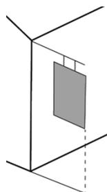
Dispositif scellé au mur, appliqué perpendiculairement à celui-ci et dont l'accroche se fait sur le haut du dispositif. Cf. schéma ci-contre.
